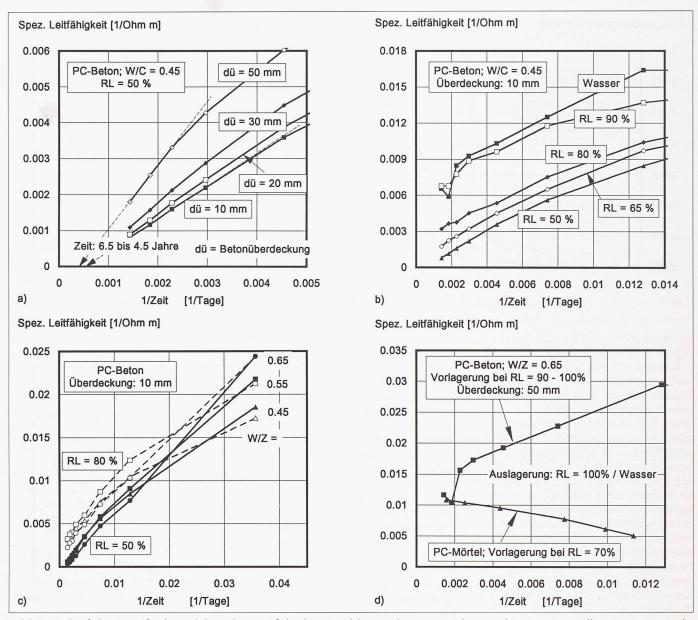
Bild 2. Verlauf der spezifischen elektrischen Leitfähigkeit in Abhängigkeit vom Kehrwert der Zeit. Darstellung zur Extrapolation des Endwertes der spezifischen Leitfähigkeit: a) Einfluss der Betonüberdeckung d<sub>v</sub> (rel. Luftfeuchtigkeit: 50%); b) Einfluss der Auslagerungsbedingungen; c) Einfluss des W/Z-Wertes und der relativen Luftfeuchtigkeit; d) Einfluss der Vorlagerung
