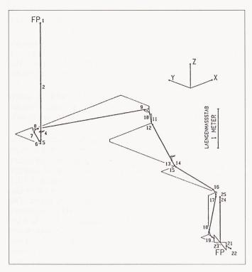
Bild 2. Berechnungsmodell «25» eines Rohrleitungssystems mit Armatur. D = 89 mm; s = 3,5 mm. Material: austenitischer Stahl
