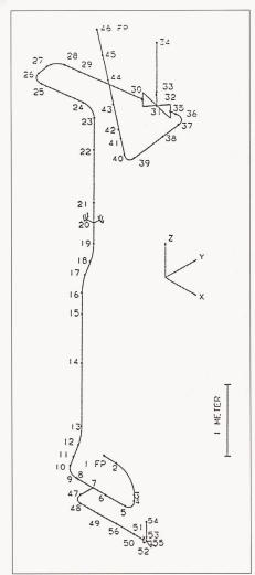
Bild 3. Berechnungsmodell «56» eines Rohrleitungssystems mit zwei Armaturen. D = 114 mm; s = 13,8 mm. Material: austenitischer Stahl
