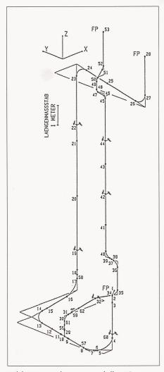
Bild 1. Berechnungsmodell «62» eines Rohrleitungssystems. Rohrleitung zwischen den Punkten  $1 \div 10 \div 28$ . D = 406,4 mm; s = 5,6 mm. Rohrleitung zwischen den Punkten  $10 \div 53$ . D = 168.3 mm; s = 2,9 mm. Material: austenitischer Stahl
