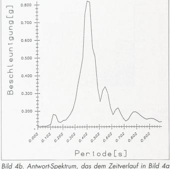
Bild 4b. Antwort-Spektrum, das dem Zeitverlauf in Bild 4a entspricht
