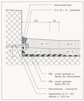
Bild 2. Anschluss 2: Geklemmter Anschluss auf Beton
