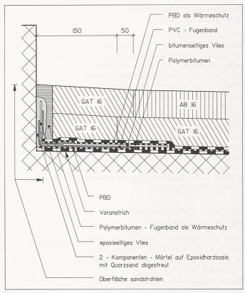
Bild 4. Anschluss 4: Geklebter Anschluss auf Kunststoffbasis, PVC-Fugenband
