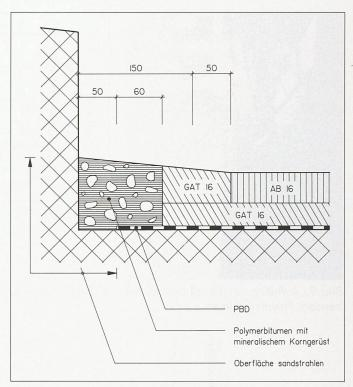
Bild 8. Anschluss 9: Geklebter Anschluss auf Bitumenbasis, Randverguss
