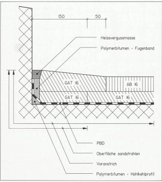
Bild 6. Anschluss 8: Geklebter Anschluss auf Bitumenbasis, PBD-Aufbordung
