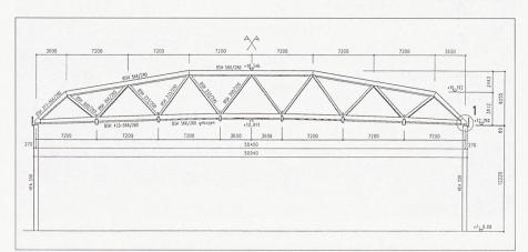
Bild 4. Längsschnitt durch einen Holzbinder der Palexpo-Halle
