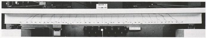
Balken 1: unbeschichtete Bewehrung, Laststufe 10: F = 388 kN, S-Faktor = 1.2
