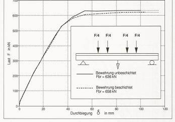
Bild 4. Last-Durchbiegungs-Diagramme für die Feldmitte. Hinsichtlich Verformung und Bruchlasten unterscheiden sich die beiden Probekörper praktisch nicht voneinander
