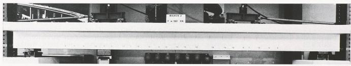
Balken 2: beschichtete Bewehrung, Laststufe 3: F = 162 kN, S-Faktor = 2.6
