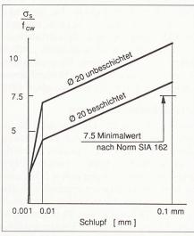
Bild 1. Schlupfdiagramme der Ausziehversuche nach Norm SIA 162/1. Schematische Darstellung des Schlupfes in Funktion der auf die Betonfestigkeit bezogenen Stahlspannungen. Das Bild zeigt die Resultate der Versuche an beschichteten und unbeschichteten Stählen Ø 20 mm. Das Haftvermögen der beschichteten Stähle ist demnach geringer, jedoch immer noch genügend. Parallelversuche an Stählen Ø 14 mm zeigten ein wesentlich günstigeres Haftvermögen als jenes der Stähle Ø 20 mm
