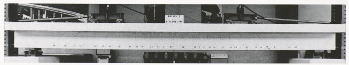
Balken 2: beschichtete Bewehrung, Laststufe 10: F = 388 kN, S-Faktor = 1.2
