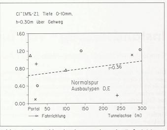
Bild 2. Mittlere Chlorid-Höhenverteilung der Tiefe 0-10 mm in den Tunnelwänden der Normal- und Überholspur, Ausbautypen A, D und E
