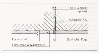
Bild 12. Elastische Fuge zwischen den Feinsteinzeugplatten
