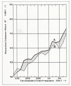
Diagramm 1: Luftschalldämmung zwischen Wohn/Esszimmern EG und 1. OG. Kurve A: mit Wandlager; R'<sub>w</sub> = 60 dB. Kurve B: ohne Wandlager; R'<sub>w</sub> = 58 dB
