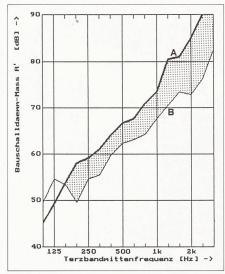
Diagramm 2: Luftschalldämmung zwischen Wohn/Esszimmern EG und 2. OG. Kurve A: mit Wandlager; R'<sub>w</sub> = 69 dB. Kurve B: ohne Wandlager; R'<sub>w</sub> = 65 dB
