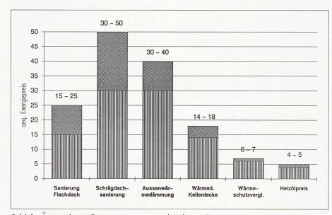
Bild 1. Äquivalente Energiepreise verschiedener Sanierungen
