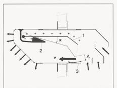
Der automatische Belüftungsrost aus den Niederlanden arbeitet mit einem druckempfindlichen Klappenventil
