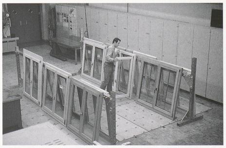
Bild 1. Holzfenster bei der Typenprüfung an der EMPA. In Zukunft werden wohl auch Aspekte der Entsorgung zu den Prüfkriterien gehören
