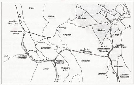
Die vom Regierungsrat des Kantons Zürich genehmigte Linienführung der 10,6 km langen Westumfahrung Zürich, die über die N20 und durch den Üetlibergtunnel die N1 und die N3 miteinander verbindet. Beim Anschluss Wettswil wird später die N4 einmünden
