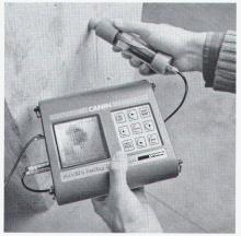
Bewehrungskorrosion aufspüren mit CANIN
