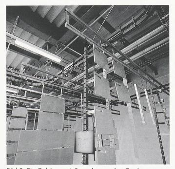
Bild 3. Ein Gehänge mit Paneelen vor dem Trockner
