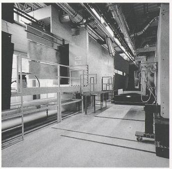
Bild 4. «Parkplatz» für die Gehänge nach der Lackierung
