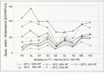
Bild 9. KKS-Mörtel, spezifische elektrische Widerstände nach 307 Tagen
