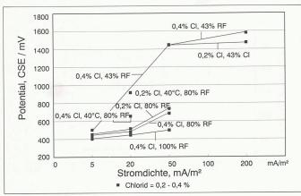
Bild 5. Anodenpotential: Ausschaltpotentiale in Funktion von Stromdichte, Klima.
