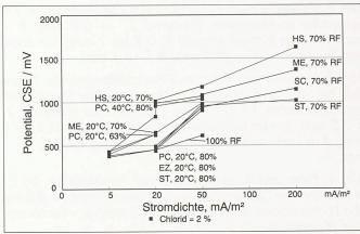
Bild 7. Anodenpotential: Ausschaltpotentiale in Funktion von Stromdichte, Klima
