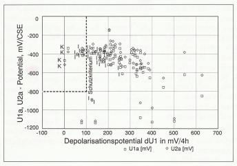
Bild 8. Depolarisationspotential dU1 in Funktion der Ausschaltpotentiale U1a, U2a. I = Schwache Lochkorrosion (Rostgrad 2, < 0,2 mm); k = Lochkorrosion (Korrosionsgrad 3, 0,2 bis 1 mm); K = Loch- und Flächenkorrosion (Rostgrad 4,5, > 1 mm).
