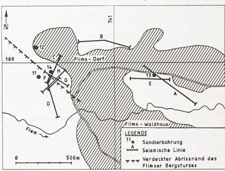
Bild 1. Ausschnitt des Projektgebietes mit Lage der Sondierungen und der seismischen Linien
