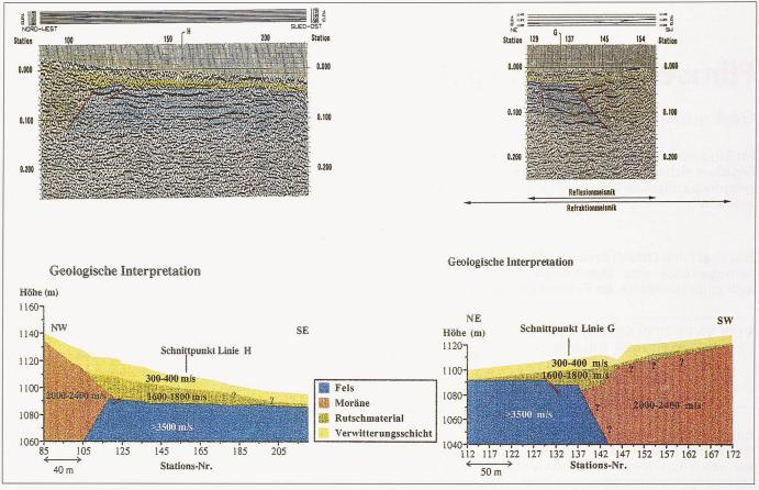
Bild 2. Reflexionsseismisches Laufzeitprofil G
