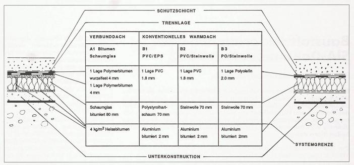
Bild 2. Systemgrenze für den Vergleich von Materialvarianten zweier Flachdachkonstruktionen
