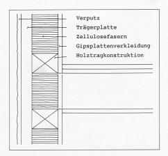
Bild 6. (links) Einfamilienhaus Winterthur: Schnitt durch Wand/ Deckenanschluss Aufbau der Aussenwand
