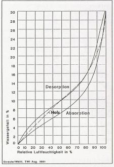
Bild 2. Sorptionsverhalten von Zellulosefasern aus Diplomarbeit Streule/ Wälti, TWI Abt. Architektur, August 1991 [4] im Vergleich zu Holz aus Norm SIA 164, Holzbau
