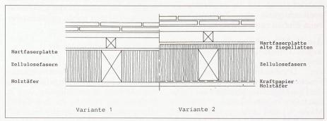
Bild 3. Amtshaus II der Stadt Zürich: Aufbau des Prüfdaches
