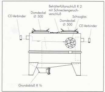
Bild 2. Fettabscheideranlage mit integriertem Olschlammfang zur Nachrüstung einer Entleer- und Spüleinrichtung
