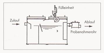
Bild 1. Fettabscheideranlage mit integriertem Ölschlammfang (alle Bilder: Passavant)
