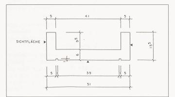
Bild 4. Querschnitt einer Sandstein-Pfeilerverkleidungsplatte. Dank modernster Technologie in den Verarbeitungswerken lassen sich solche Profile heute schnell und wirtschaftlich herstellen
