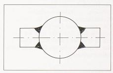
Bild 1. Nicht durchgeschweisste Nähte, nicht volumetrisch prüfbar
