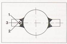
Bild 2. Vollangeschlossene Nähte, gut Ultraschall-prüfbar, QB möglich
