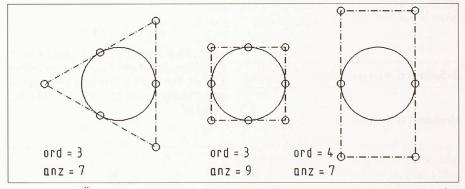
Bild 10. Der Überstreichungswinkel eines Kreisbogens ist < 180°. Kreise werden in der Praxis aus 3 oder 4 Abschnitten zusammengesetzt
