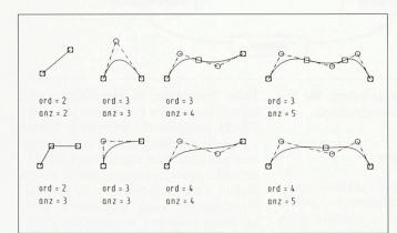
Bild 1. Beispiele einiger B-Splines. Es gilt: Ordnung ist gleich Grad plus eins. Die Ordnung ist mit «ord» und die Anzahl der Pole mit «anz» bezeichnet. Die Pole sind mit – markiert
