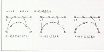
Bild 6. Das Bild der Kurve wird festgelegt, indem man die u-Werte in den Punkten M<sub>1</sub>M<sub>2</sub>M<sub>3</sub> bestimmt
