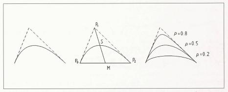
Bild 8. Bei Rationalen B-Splines kann die Linie  $P_1M$  geschnitten werden mit Kegelschnitt als Resultat (Parameter  $\rho = SM/P_1M$ )
