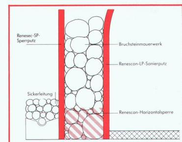
Die Renescos-Horizontalsperre verhindert das Aufsteigen der Feuchtigkeit. Das Mauerwerk trocknet aus.
