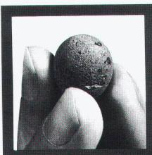
Das Leichtgranulat aus gebranntem Ton
