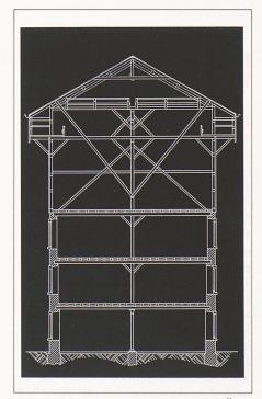
Schnitt durch den Hänggiturm: Über dem dreigeschossigen Unterbau erhebt sich das Holztragwerk als einfache, aber ausgereifte Riegel- und Binderkonstruktion (Firsthöhe ab Terrain 24.20 m)
