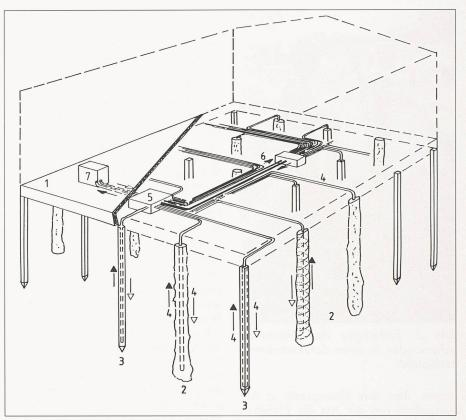
Bild 1. Schematische Darstellung einer Energiepfahl-Anlage mit verschiedenen Pfahltypen: 1 – Bodenplatte, 2 – Ortsbetonpfahl, 3 Fertigbetonpfahl, 4 – Wärmeund Kühlkreisläufe, 5 – Verteilerkasten, 6 – Wärmepumpe
