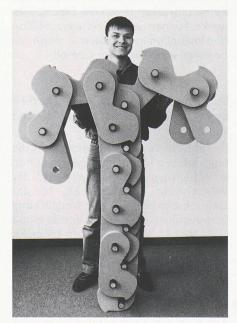
Serge Bringolf zeigt mit seiner originellen Erfindung, die aus zwei reissverschlussartig ineinandergreifenden Ketten besteht, wie eine steife Struktur erzeugt werden kann
