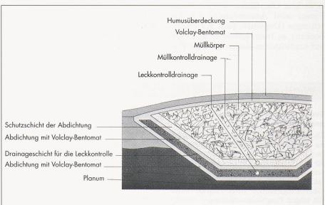
Schematische Darstellung der Abdichtung einer Deponie
