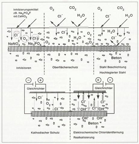
Bild 2. Möglichkeiten des zusätzlichen Korrosionsschutzes bei Stahlbeton
