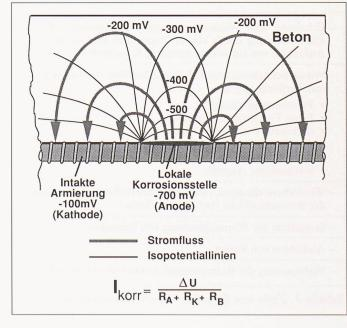
Bild 1. Verstärkte lokale Korrosion an einem Stahl infolge Makroelementbildung
