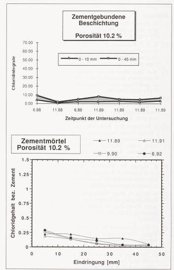
Bild 9. a) Schichtintegrale Feld 2; b) Chloridprofile für Feld 2
