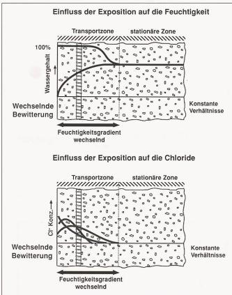
Bild 13. Einfluss der Exposition (schematisch), wechselnder Feuchtigkeitsgradient vorherrschend
