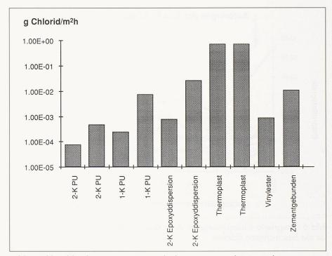
Bild 4. Chloriddurchgang von 10 Beschichtungen aus Laborversuchen
