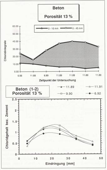
Bild 11. a) Schichtintegrale Zwischenfeld 1-2; b) Chloridprofile Zwischenfeld 1-2
