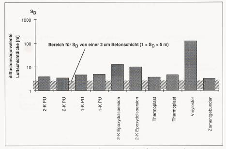
Bild 5. Diffusionsverhalten gegenüber Wasserdampf (Laborversuche)
