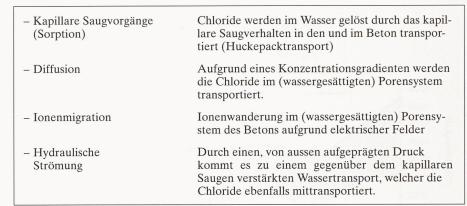
Tabelle 3. Möglichkeiten des Transportes von Wasser und Chlorid in Beton
