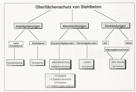
Bild 3. Schematische Darstellung der Möglichkeiten beim Oberflächenschutz
