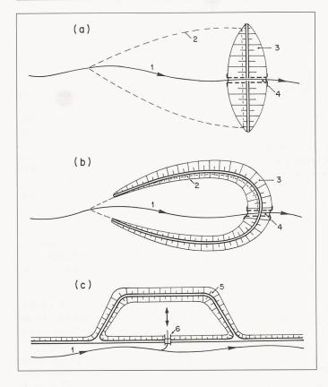
Bild 2. Typen von Hochwasserrückhaltebecken; schematische Situation eines Staubeckens, a) Flachbeckens, c) Beckens im Nebenschluss. Fliessgewässer, 2. Beckenausdehnung beim Bemessungshochwasser, 3. Sperre, 4. Durchlass als Drosselung, Polderdamm, 6. Siel
