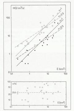
Bild 8. Hydrologische Merkmale der schweizerischen Hochwasserrückhaltebecken. a) Abhängigkeit der Spitzen HQ<sub>B</sub> der Bemessungshochwasser (O) sowie der zugehörigen Ausflussspitzen HQ<sub>A</sub> (•) vom Einzugsgebiet. b) Quotient K in Abhängigkeit der Grösse des Einzugsgebietes E
