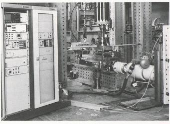
Bild 2. Versuchseinrichtung; Links: Elektronische Steuereinheit, - Mitte: Prüfmaschine mit Probekörpern und vertikaler Belastung, - Rechts: Servozylinder mit Zug-Druck-Kraftmessdose zur Registrierung des Reibungswiderstandes
