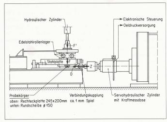
Bild 1. Versuchsanordnung zur Bestimmung der Festkörperreibung, Bezeichnungen: - Z: Reibungswiderstand in Zugrichtung, - D: Reibungswiderstand in Druckrichtung, - F': Hydraulische Kraft, - G: Eigenlast der Versuchseinrichtung, - F: Normalkraft F = F' + G
