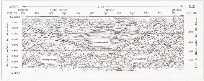
Bild 1. Seismisches Profil quer über die Magadino-Ebene bei Cadenazzo. Die Datenqualität ist ausgesprochen gut, was auf die horizontale Schichtungsstruktur der quartären Talfüllung und auf den markanten Schallhärtekontrast zwischen dem Lockermaterial und den darunterliegenden Gneisen zurückzuführen ist
