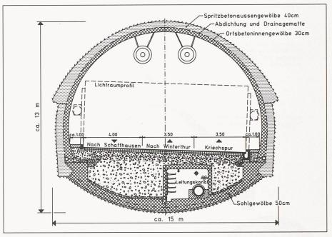
Bild 3. Normalprofil 3-Spur-Tunnel
