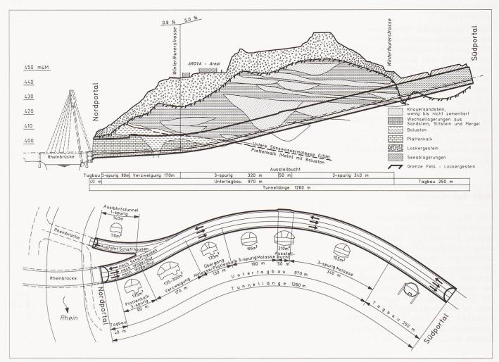
Bild 2. Geologisches Längenprofil und schematischer Grundriss
