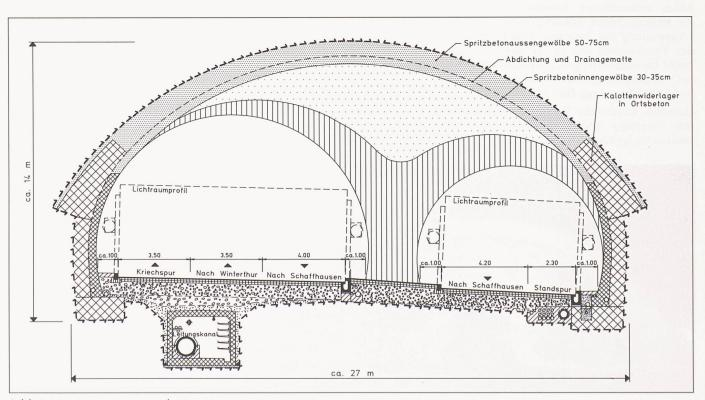
Bild 4. Verzweigungsquerschnitt
