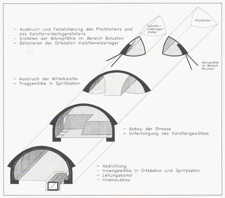
Bild 5. Bauvorgang Verzweigung
