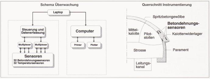
Bild 13. Instrumentierung zur Messung der Gewölbekraft
