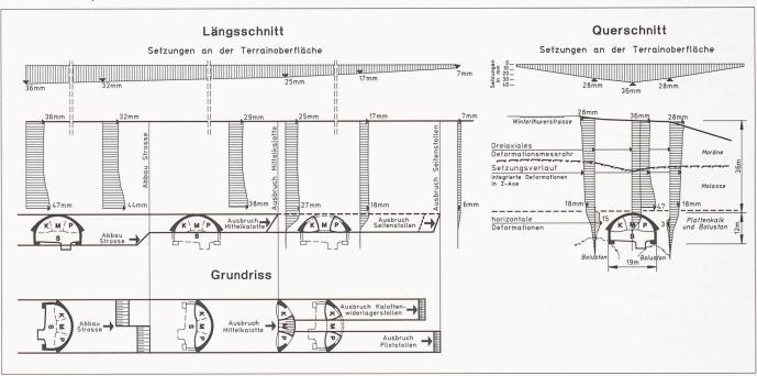
Bild 12. Messquerschnitt in der Verzweigung
