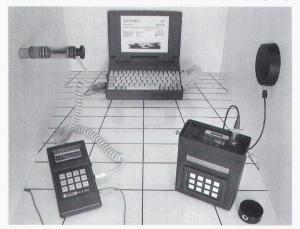
COLEBRAND KORROSION-DETECTOR COLEBRAND BETON DECUMETER
