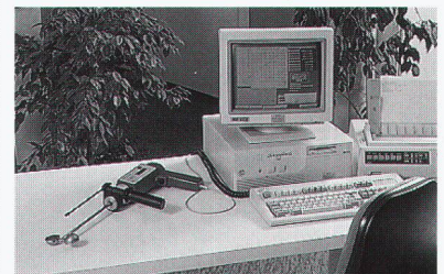
PC-Anschluss garantiert belegbare Betonqualität.
