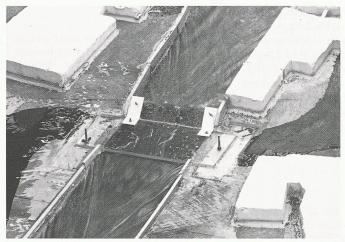
Bild 2. Abfluss unter der modifizierten Cimavilla-Brücke im hydraulischen Modell, bei ähnlichen Abfluss- und Geschiebeverhältnissen wie auf Bild 1
