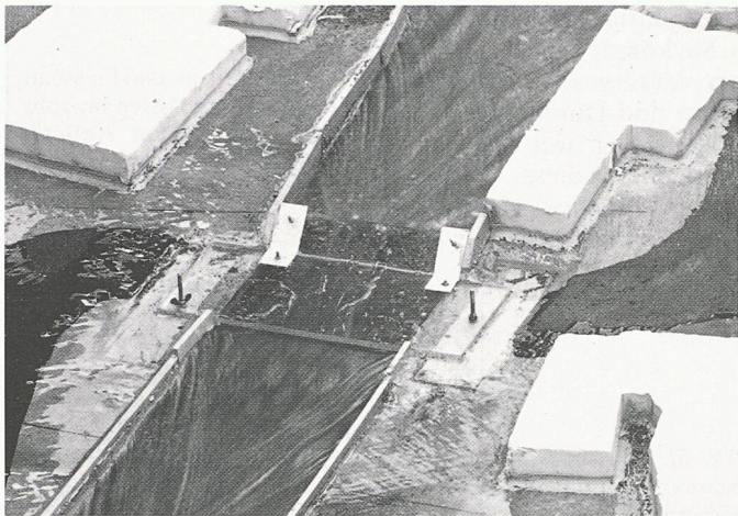
Bild 2. Abfluss unter der modifizierten Cimavilla-Brücke im hydraulischen Modell, bei ähnlichen Abfluss- und Geschlebeverhältnissen wie auf Bild 1
