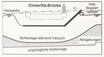
Einklang mit den früher zitierten Versuchen kann auch da festgestellt werden, dass auf einer beweglichen Sohle eine partielle Verklausung nie zu einer vollständigen Verlegung des Abflussquerschnitts führen kann. Selbstverständlich wirkt aber ein Holzteppich mit zunehmender Grösse mit der Zeit störend. Es scheint aber möglich, dass in einem solchen Falle eingegriffen werden kann, um die Grösse des Teppichs zu begrenzen.
