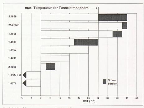
Bild 6. Spaltkorrosionstest in 10%-FeCl<sub>3</sub>-Lösung
