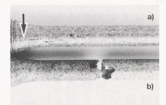
Bild 4. Spannungsrisskorrosion am Werkstoff 1.4305: a) Risse parallel zur Probenachse bei unbelasteten Proben; b) Brüche quer zur Probenachse bei belasteten Proben
