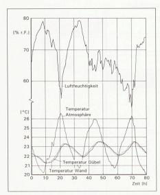
Bild 8. Temperatur der Luft, der Tunnelwand und eines in der Tunnelwand montierten Dübels sowie die Luftfeuchtigkeit im Gubristtunnel, Schweiz.
