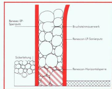
Die Reneson-Horizontalstopper verhindert das Aufsteigen der Feuchtigkeit. Das Mauerwerk trocknet aus.
