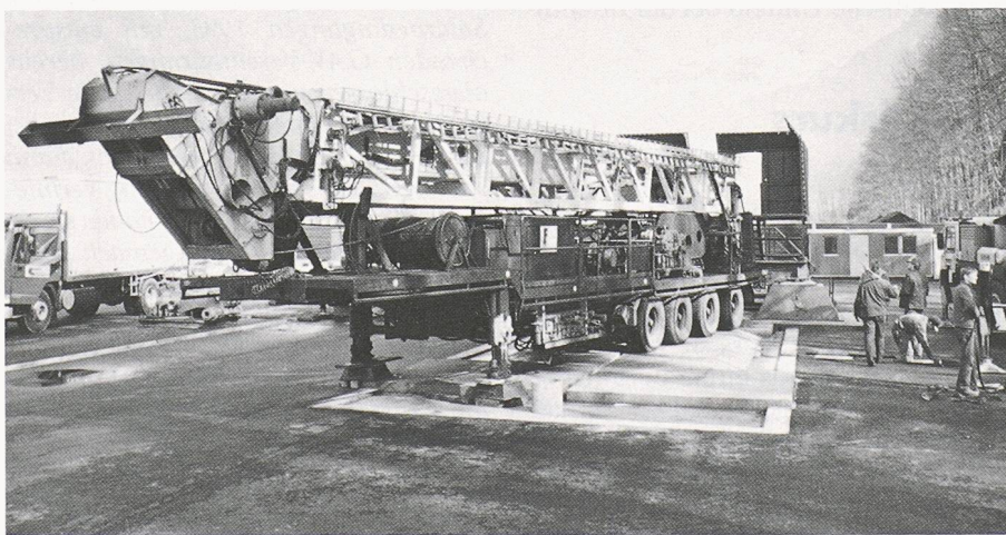
Das fahrbare, rund 60 t schwere Bohrgerät wird mit Hilfe von Pneukranen auf- und abgebaut. Das Kernstück der Anlage (im Bild) besteht aus dem Hebework mit Flaschenzugsystem, einem Antriebsmotor und dem Teleskopmast, die auf einem Sattelaufleger montiert sind (Bild: Nagra)
