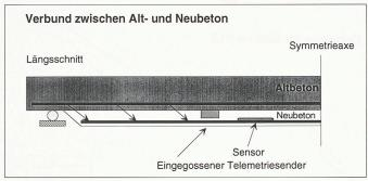
Bild 1. Versuchsaufbau mit einbetoniertem Sensor und Telemeter
