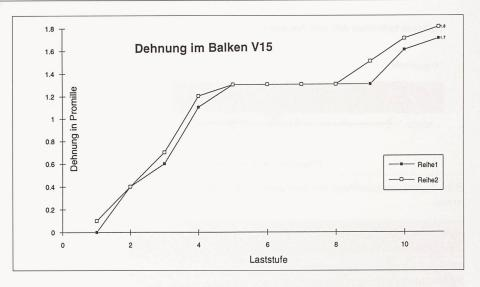
reich. Unter der Annahme des Ebenbleibens der Querschnitte kann so auf parallel gerichtete Dehnungen im Betoninnern auf Höhe unserer Dehnungssensoren geschlossen werden. In Bild 6 ist der Vergleich der beiden Messarten an einem Versuchskörper dargestellt. Die beiden Dehnungswerte sind dargestellt in Promille. Die vertikale Verschiebung der Messwerte ist auf die anfänglich fehlende Kraftschlüssigkeit der neuen Sensoren zurückzuführen.
