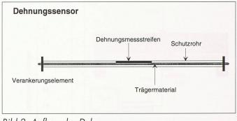
Bild 2. Aufbau des Dehnungssensors
