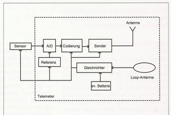
Bild 4. Blockdiagramm des Telemeters
