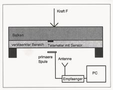
Bild 5. Versuchsanordnung mit PC und Empfangsstation
