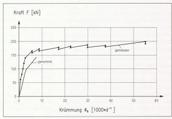
Bild 11. Vergleich der rechnerischen Krümmung  $\Phi_{\mathbb{B}}$  über dem mittleren Auflager des CFK-verstärkten Durchlaufträgers mit Messwerten eines gleich starken Stahlbetondurchlaufträgers
