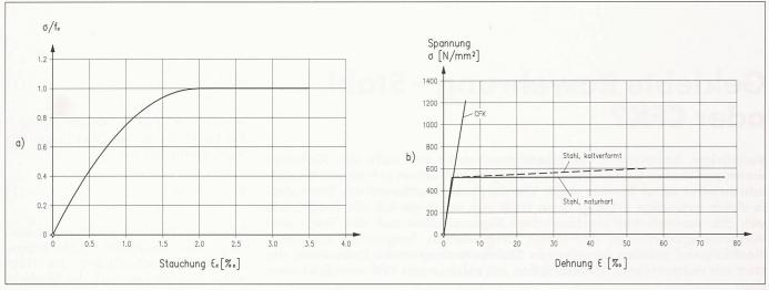
Bild 1. Normierte Spannungs- Dehnungsdiagramme für Beton (a, links) und für Stahl (b, rechts)
