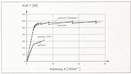
Bild 4. Vergleich der gemessenen Krümmung  $\Phi$  in Balkenmitte mit den rechnerischen Werten bei einem stahl- bzw. CFK-verstärkten Balken
