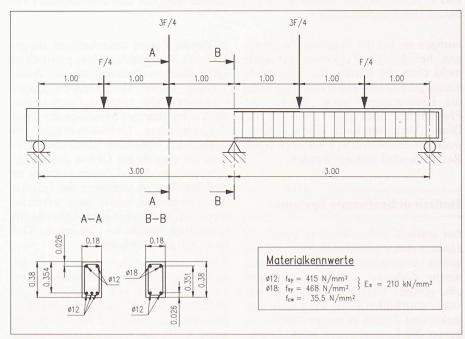
Bild 6. Abmessungen, Bewehrungs- und Lastanordnung des untersuchten Stahlbetondurchlaufträgers
