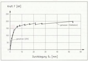
Bild 10. Vergleich der rechnerischen Durchbiegungen  $\delta_A$  im Schnitt A für den CFK-verstärkten Durchlaufträger mit Messwerten eines gleich starken Stahlbetondurchlaufträgers
