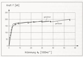
Bild 8. Verlauf der gemessenen und gerechneten Krümmung  $\Phi_{\text{B}}$  über der Mittelstütze für den stahlverstärkten Durchlaufträger
