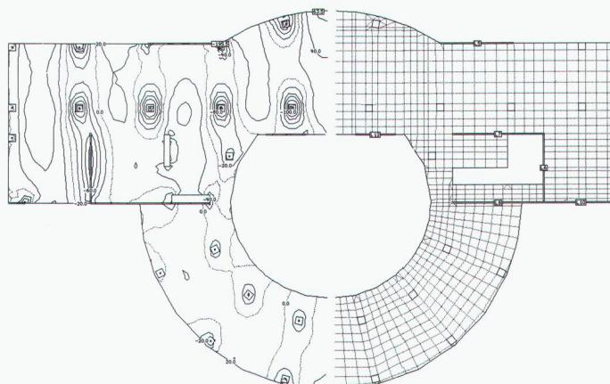
**CEDRUS-3:** Platten u. Scheiben mit Finiten Elementen, Vorspannung (in Vorbereitung)
