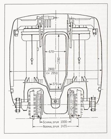
Bild 4. Skizze eines umspurbaren Fahrgestelles System Talgozug [2]
