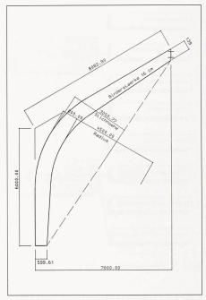
Bild 11. Mit dem Variantenmodul automatisch erzeugter Bogenbinder
