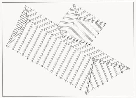
Bild 10. Mit dem Dachstuhlmodul automatisch erzeugte Dachform
