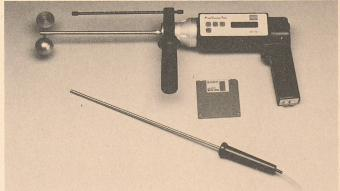
Frischbetonmessgerät FCT 101 mit zugehöriger Temperatursonde. Am Display sind in Sekundenschnelle vier Messdaten ablesbar
