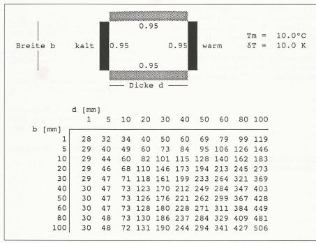
Bild 1. Ersatz-Wärmeleitfähigkeitswerte in [mW/(m·K)] für die Berechnung des horizontalen Wärmetransfers in langen Lufthohlräumen mit isolierten Verbindungen zwischen der warmen und der kalten Seite (aus [1]). Die Emissionszahlen sind überall 0.95. Die tabellierten Zahlen sind Durchschnittswerte für die liegende und stehende Lage des Hohlraums.
