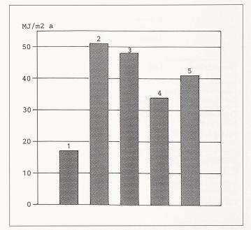
Bild 4. Jahresenergiebedarf verschiedener Klima- und Kühldeckensysteme. 1: Fensterlüftung mit Wasser-Kühldecke; 2: Mischlüftungssystem mit variablem Volumenstrom; 3: Quellüftungssystem mit variablem Volumenstrom; 4: Quellüftungssystem mit minimaler Aussenluftzufuhr und Wasser-Kühldecke; 5: Quellüftungssystem mit variablem Volumenstrom und Luft-Kühldecke. Quelle: INTEP
