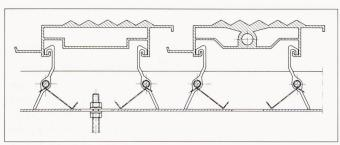
Bild 5. Profile von wasser- (links) und luftführenden Kühldeckenlamellen (rechts). Bild: BARCOL-AIR
