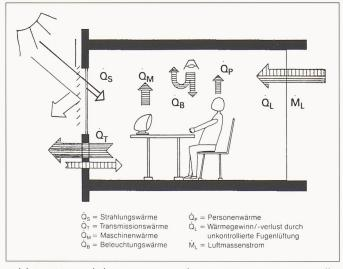
Bild 1. Wärmebilanz eines modernen Büroraumes. Quelle: Bauzeitung
