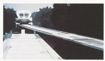
Bild 10. Spurwechsel über eine Stahlbiegeweiche
