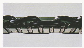
Bild 5. Statorpakete mit Wanderfeldwicklungen – beidseitig längs unterhalb des Fahrweges
