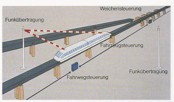
Bild 11. Bahnbetriebsleittechnik für Fahrweg und Fahrzeuge der Magnetschnellbahn
