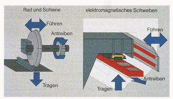
Bild 1. Beim Transrapid tritt an Stelle des Rad/Schiene-Systems ein berührungsfreies elektromagnetisches Schwebeund Antriebssystem
