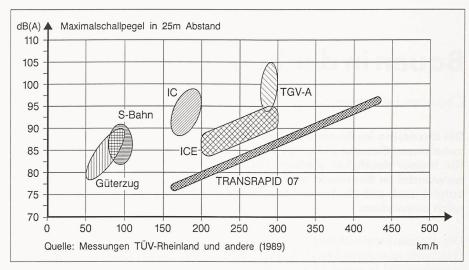
Bild 13. Schallmessungen für Transrapid TRO7 und herkömmliche Bahnsysteme
