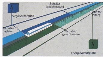
Bild 7. In Abschnitte unterteilter Langstator-Linearmotor im Fahrweg – eingeschaltet nur im befahrenen Abschnitt
