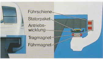
Bild 2. Anziehende Kräfte der Elektromagnete im Fahrzeug und ferromagnetische Reaktionsschienen im Fahrweg für das Schwebesystem
