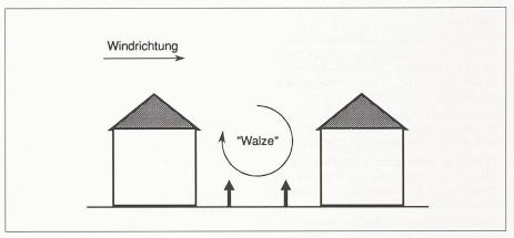
Bild 5. Walzenbildung innerhalb einer Strassenschlucht. Durch das lange Verbleiben der Abgase innerhalb des Strassenbereiches kann es zu einer Anreicherung von Schadgasen und Wärme kommen
