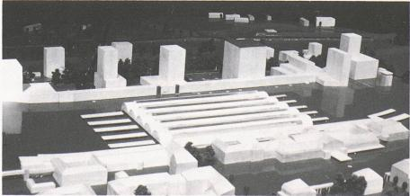
Bild 1. Windkanalmodell eines Untersuchungsgebietes innerhalb der Stadt Karlsruhe. Die obere Abbildung zeigt den Ist-, die untere den Planzustand
