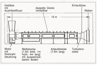
Bild 2. Aufbau eines Grenzschichtwindkanals. Strömungsrichtung von rechts nach links
