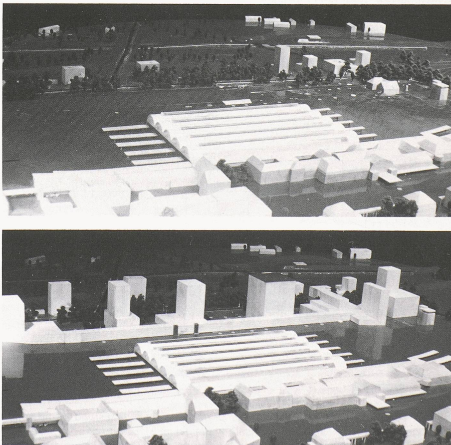
Bild 1. Windkanalmodell eines Untersuchungsgebietes innerhalb der Stadt Karlsruhe. Die obere Abbildung zeigt den Ist-, die untere den Planzustand
