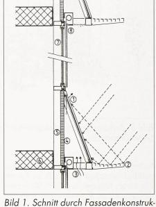
Bild 1. Schnitt durch Fassadenkonstruktion eines Bürogeschosses. 1 – Photovoltaik; 2 – Reflektierende Chromstahlamellen; 3 – Hinterlüftung; 4 – Thermische Isolation; 5 – Pfosten-Riegel-Metallkonstruktion; 6 – Geschossdecke; 7 – Metallfenster; 8 – Stoffrollo
