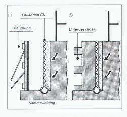
grund und Bodenplatte bei horizontalem Einsatz. Die Matte passt sich mühelos jedem Untergrund an, ist unverrottbar und leicht zu verarbeiten. Der Einsatz von Enkadrain CK bedeutet auch: weniger Aushub, keine Abdichtung der Aussenwand, keine Filter- und Sickerschicht, keine Baugrubenverfüllung!
