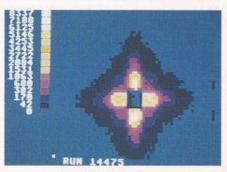
Veränderungen der Intensität der an einem Nickel-Aluminium-Einkristall gestreuten Neutronen nach unterschiedlicher Dauer einer Wärmebehandlung bei 1100° C: Oben ohne Wärmebehandlung, Mitte nach 5 Minuten, unten nach 2 Stunden. Aus diesen Bildern wird die Kristallform und die Gestaltänderung der festigkeitsbestimmenden mikrokristallinen Ausscheidungen in dieser Superlegierung bestimmt.
